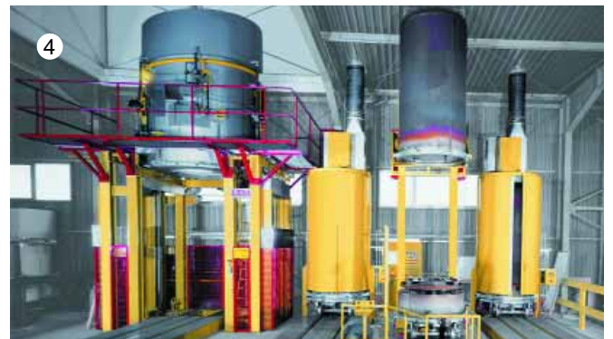
3 Förderband-Durchlauf-Ofen 600 °C Continuous conveyor furnace
