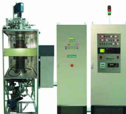
Kristallzuchtssystem für 2" SiC-Kristalle (4H/6H) Crystal growing system for 2" SiC-crystals (4H/6H)
